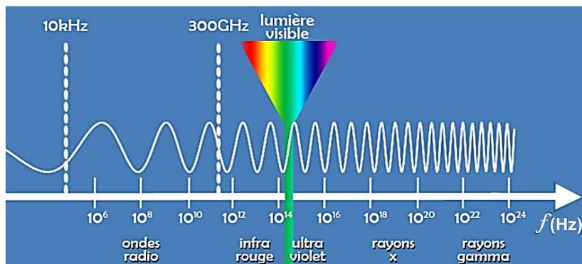
Figure 3 : spectre électromagnétique des ondes. © CEA
